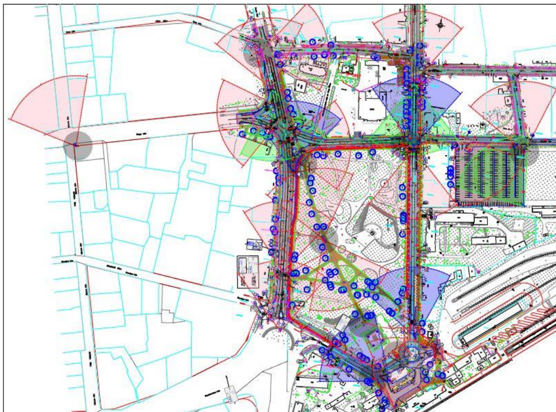
6. attēls. CCTV uzstādīšanas plāns
