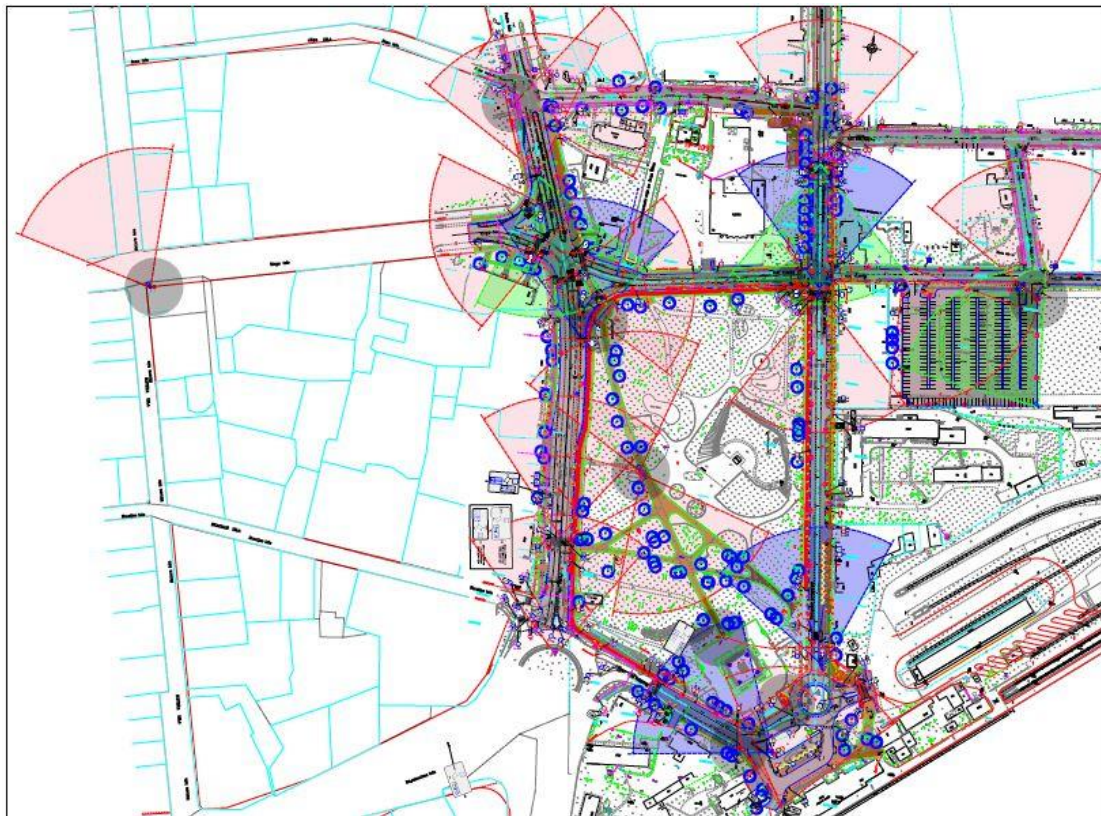
6 pav. Vaizdo stebėjimo ir įrašymo sistemos įrengimo planas
